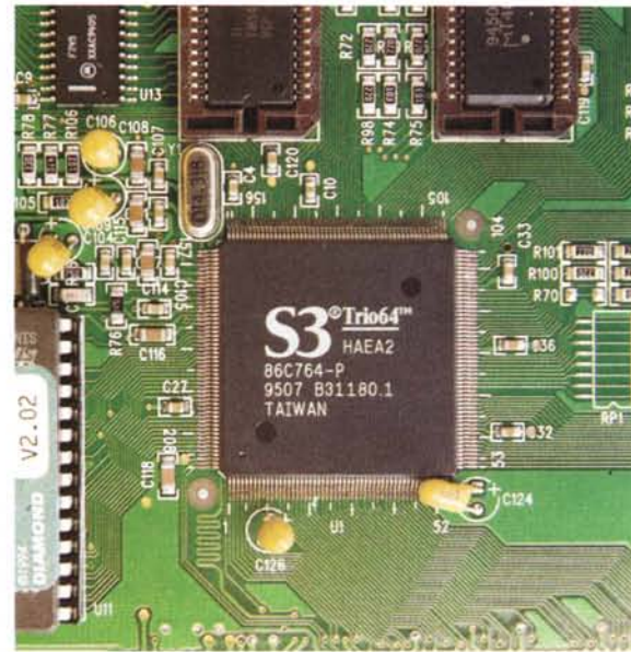
Figura 2 - Primo piano sul chip S3 della Stealth.
