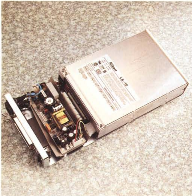
A sinistra il CoolScan appena aperto (si noti la somiglianza con una comune unità 5.25"). Qui sopra l'interno dello scanner vero e proprio.
