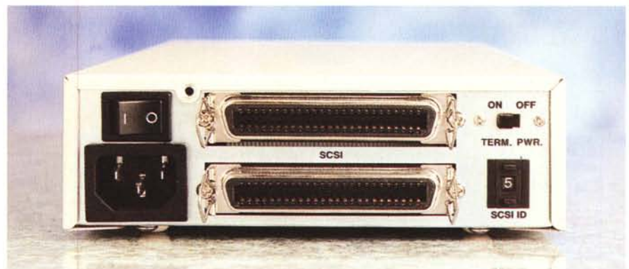
Sul retro, interruttore, alimentazione, porte e indirizzamento SCSI.
