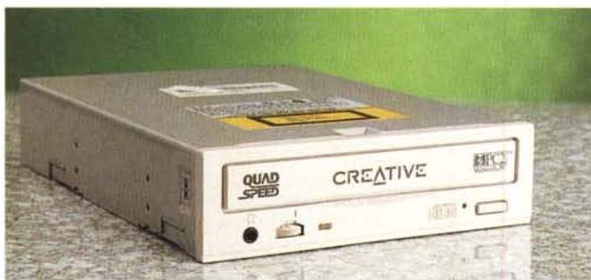
Il lettore Creative Quad Speed è un drive IDE a quadrupla velocità che può essere settato come unità master o slave per l'inserimento in una catena di dispositivi IDE.
