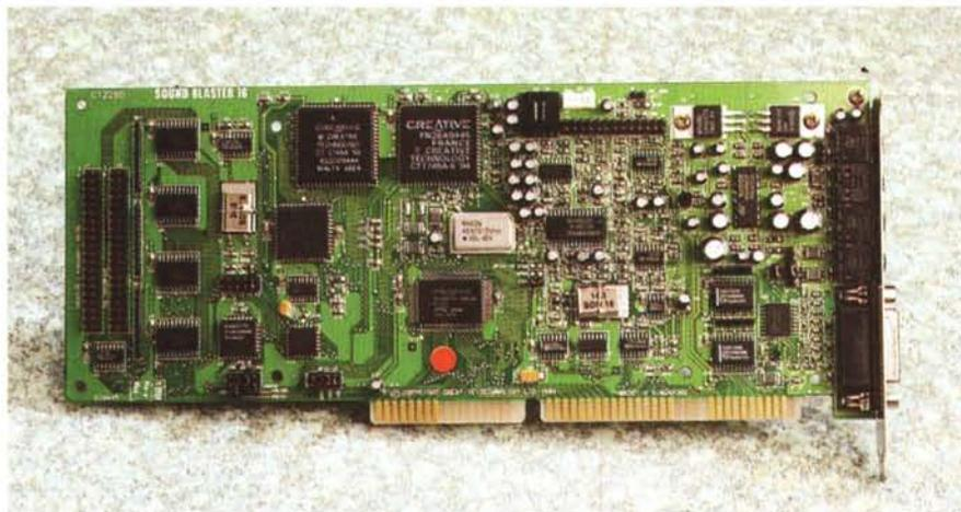
La scheda Sound Blaster 16 ASP, oltre alle funzionalità audio, offre un'interfaccia IDE per il collegamento del drive CD-ROM.
