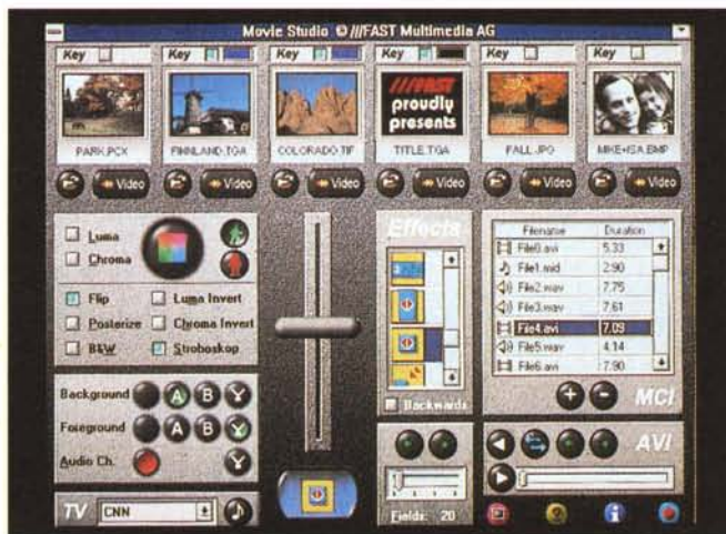
Movie Studio è la sofisticata interfaccia software che consente di sfruttare tutte le possibilità offerte dalla scheda Movie Machine II: mixer, dissolvenze, picture in picture, crawl, compressione, controllo delle chiavi di luminosità e cromaticità, overlay, acquisizione di fotogrammi, controllo del tuner TV.
