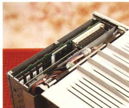
A sinistra è visibile il rullo sul quale viene trattenuto il foglio durante la stampa. Qui in alto è visibile uno «scorcio» dell'elettronica.
