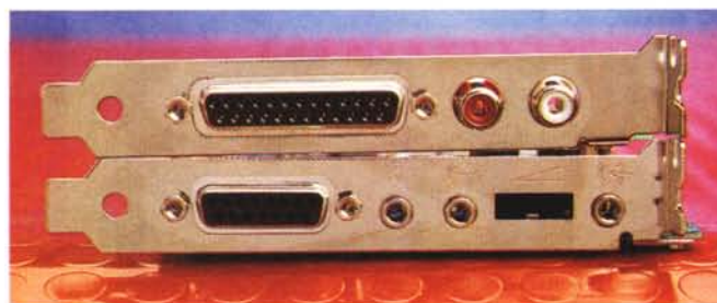
◀ Ecco come appaiono le connessioni al Multimedia Kit; oltre alle connessioni audio sono presenti la porta SCSI ed una porta MIDI utilizzabile anche per l'inserimento di un joystick.
