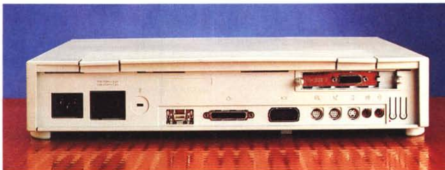
Sul retro le interfacce standard Macintosh. Si noti il connettore della DOS Compatibility Card.
