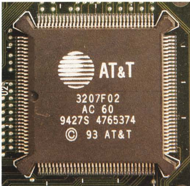
Uno dei quattro DSP 3207 a 66 MHz di produzione AT&T.
