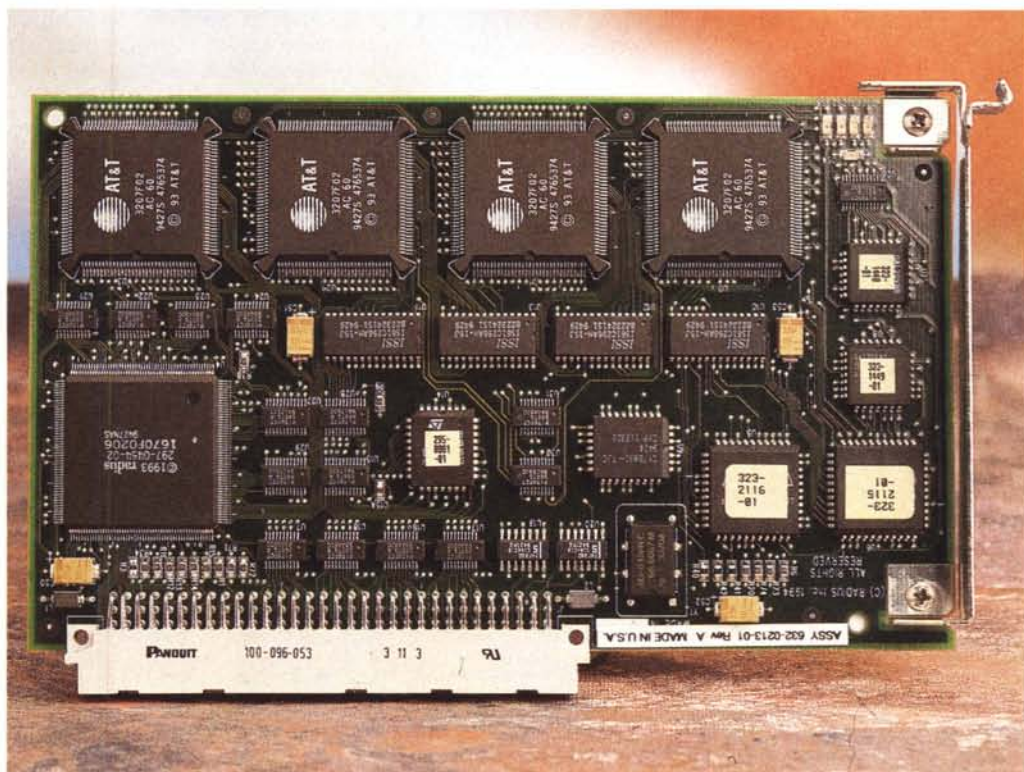
La Radius PhotoEngine utilizza quattro microprocessori DSP a 66 MHz di produzione AT&T.
