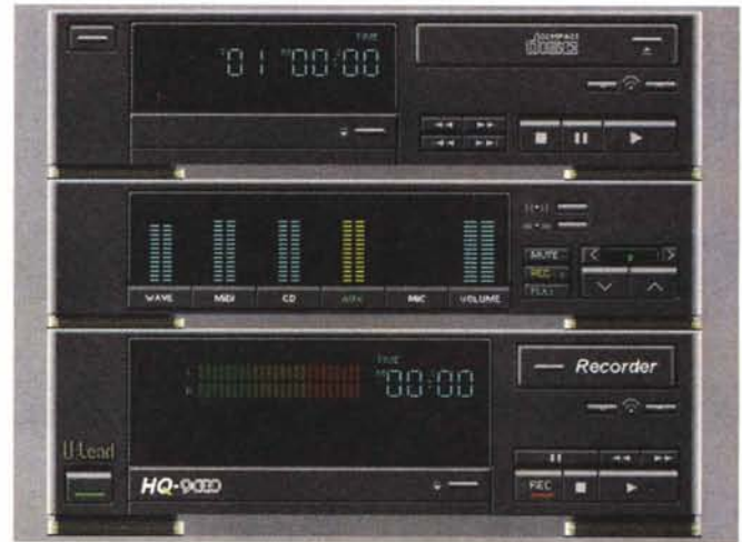
Figura 11 - Lead HQ-9000. In versione «Compact & MIDI» l'HQ-9000 è un rack digitale capace di gestire il Play di sintesi sonora, file MIDI e CD audio più la registrazione, via linea, delle stesse fonti oppure di un microfono esterno.
