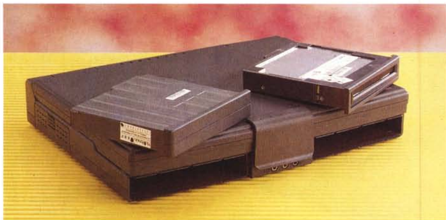
Anteriormente troviamo la batteria ricaricabile e il drive da 1.4 MB.
