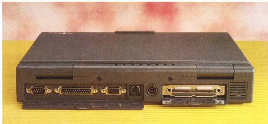
Sul retro le connessioni standard più una porta per il collegamento ad una docking station.
