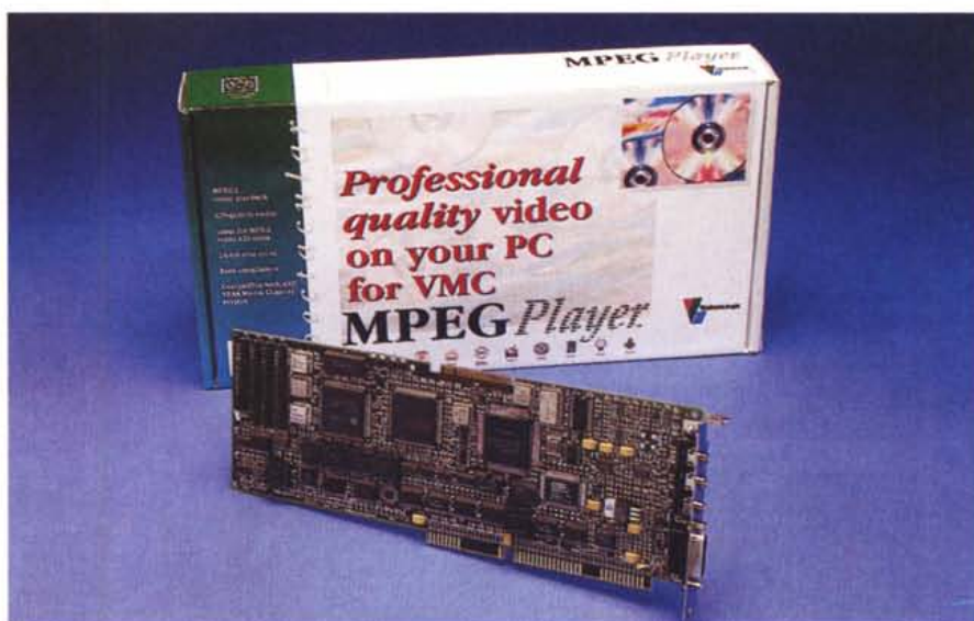
VideoLogic MPEG Player, controller di playback in MPEG, da associare a schede della linea Movie via VMC.
