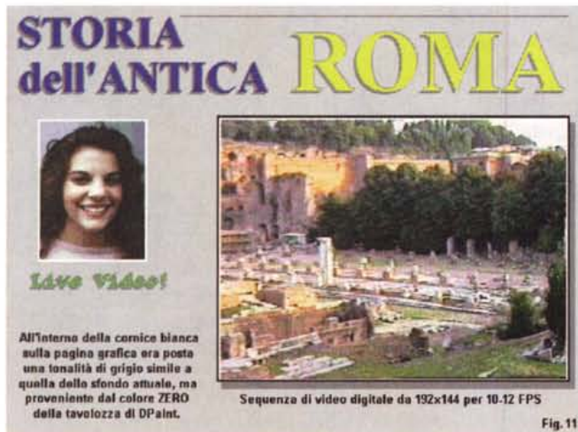
Figura 11 - Oltre al file ANIM che scorre, possiamo forare il colore dello sfondo ed inserire, grazie ad un economico genlock, il segnale analogico di una video-ripresa. Quest'ultima sarà in presa diretta con il soggetto a parlare e muoversi proprio mentre viene eseguito il file ANIM!
