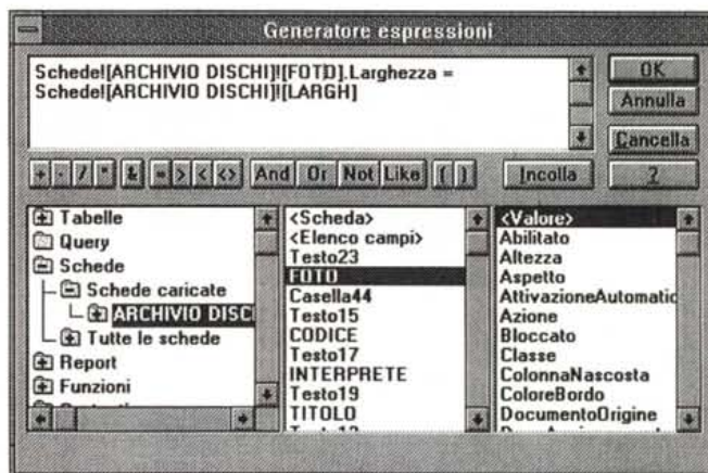
La figura mostra la sintassi di un comando Access da usare quando si desidera che la dimensione del campo immagine sulla scheda cambi in funzione della dimensione effettiva della immagine memorizzata in un campo numerico.
