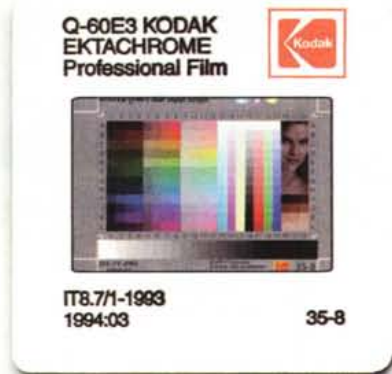
La diapositiva di test fornita a corredo permette la taratura secondo il sistema DCR messo a punto dalla stessa Microtek.
