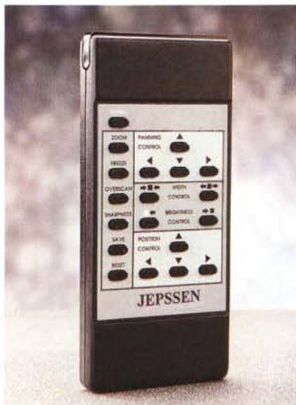
Un «necessario» utilissimo è il telecomando in dotazione con l'Encoder Pro. Molto completo, ci permette di selezionare le diverse funzioni, tra cui l'accensione dell'apparecchio, l'overscan e lo zoom, il controllo dell'area e del posizionamento dell'immagine.
