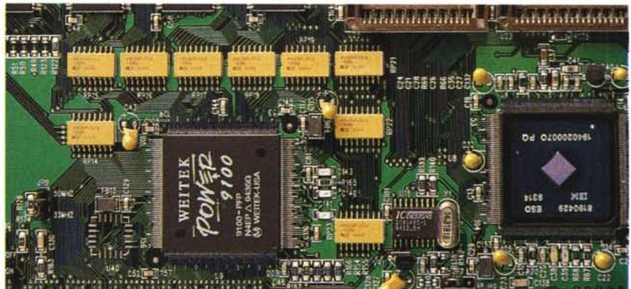
Close-up sul controller grafico Weitek P9100 a 32 bit e sul chip IBM DAC RGB 525.
