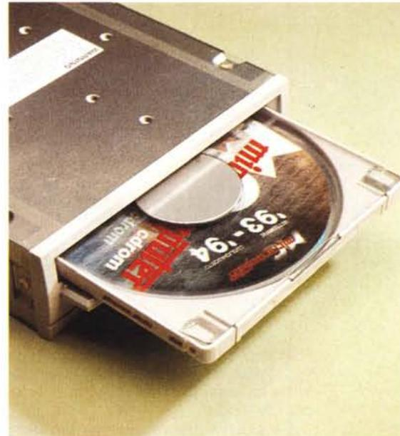
accesso inferiore ai 190 msec. Ed è interfacciabile tramite una SCSI2.
