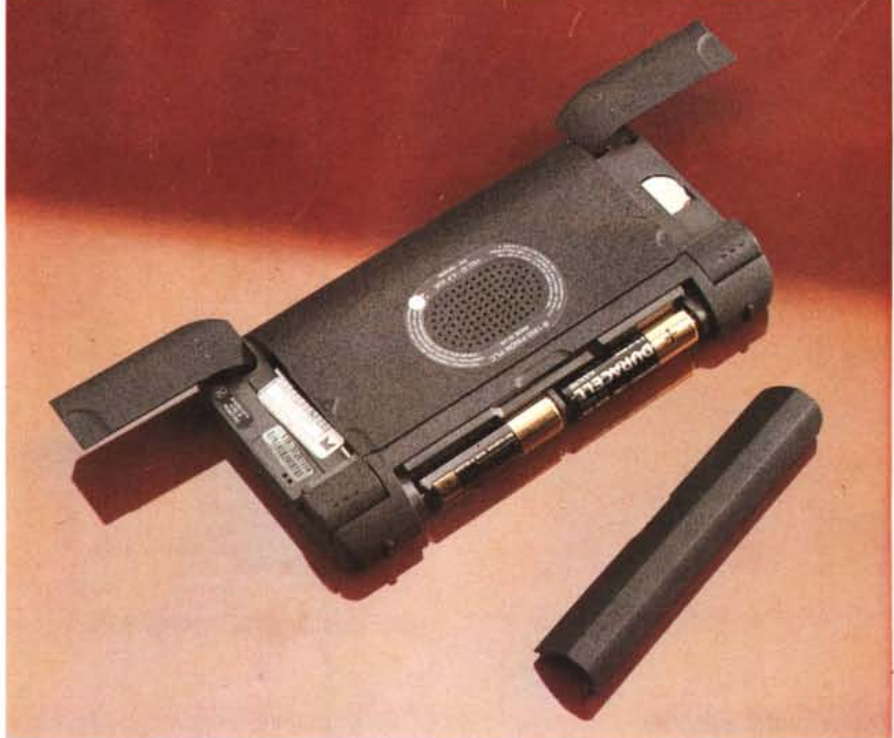
Il vano batteria, gli alloggiamenti per le espansioni RAM/ROM, l'altoparlantino di sistema.
