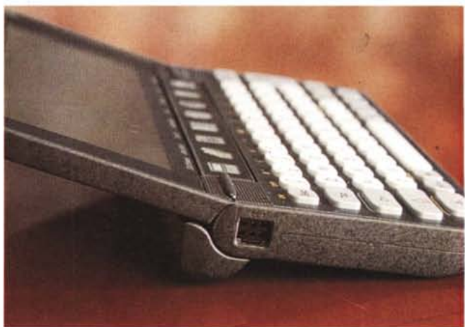
Sul lato destro troviamo la presa per l'alimentatore esterno (non fornito a corredo), sul lato sinistro la presa per il collegamento degli accessori esterni.
