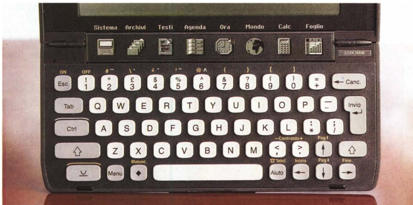
La tastiera, pur di dimensioni ridotte, si utilizza piuttosto agevolmente. In alto i tasti a sfioramento per accedere alle applicazioni.
