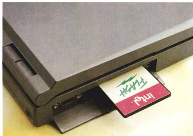
L'alloggiamento per le schede PCMCIA e la porta video sono situati sul lato sinistro.
