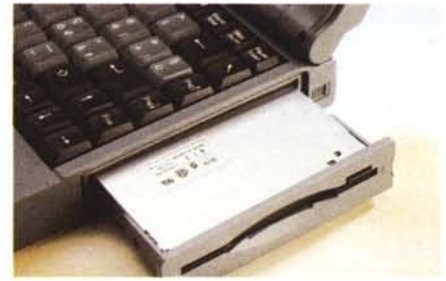
Il drive estraibile per floppy disk da 1.4 megabyte.
