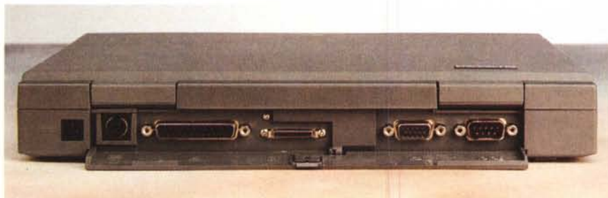
La completa dotazione di porte I/O: seriale, parallela EPP (Enhanced Parallel Port), SVGA, tastiera/mouse e unità floppy disk entrambe esterne.
