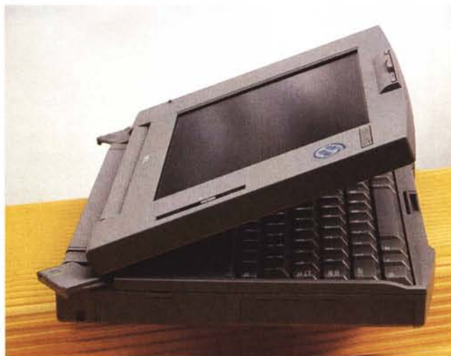
► Il display si può girare ed il Versa M si tramuta in una tablet.
