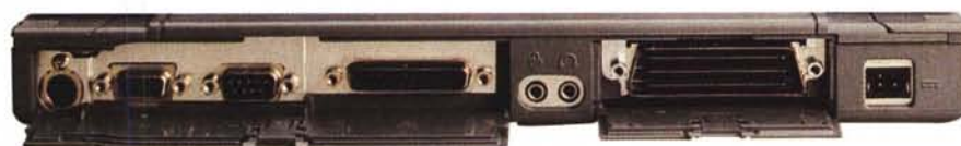
▲ Le varie porte di I/O. Si noti oltre alle prese audio il grosso connettore per il collegamento con la Docking Station.
