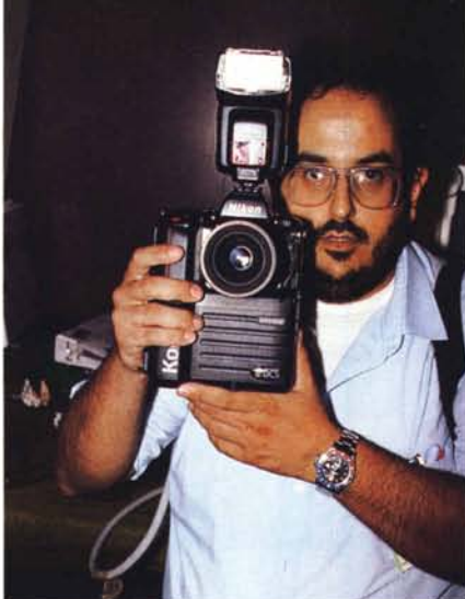
Regina della «Photokina Digitale», la Kodak DCS 460 utilizza un CCD a colori da sei milioni di pixel. In secondo piano il sottoscritto, ormai in estasi godereccia...
