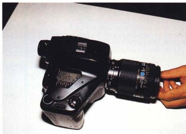
La Nikon E2 si impugna e si utilizza come una normale fotocamera reflex. Sul lato superiore, oltre ai comandi principali, troviamo anche un piccolo display LCD per il controllo delle funzioni.
