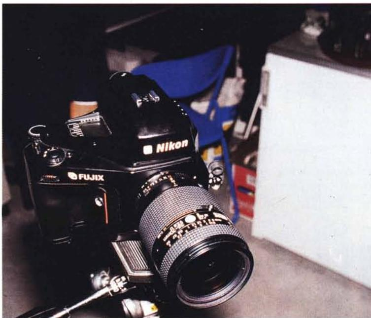
chio (e sfruttando la profondità dello stesso) è stato inserito un condensatore ottico che riduce l'angolo di copertura alle dimensioni del CCD utilizzato. Grazie a questo artificio, si ha corrispondenza tra la focale utilizzata e l'angolo di campo effettivamente ripreso, nonostante le dimensioni inferiori del sensore.
