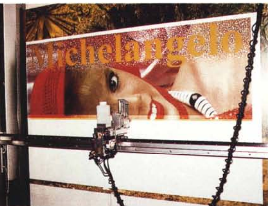
Questo gigantesco plotter a parete, oltre a realizzare vere e proprie gigantografie, permette la stampa sia su tessuti che su tappeti.
