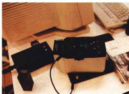
Il dorso Rollei ChipPack utilizza tre passaggi per riprendere immagini a colori.
