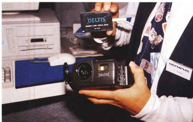
L'apparecchio Deltis, completamente digitale, è dedicato al mercato consumer. È dotato di mirino elettronico a colori, memorizza le immagini su scheda PCMCIA e utilizza batterie ricaricabili da videocamera.
