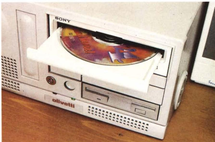
Il drive per il CD-ROM è del tipo senza «caddy», più veloce da impiegare. Ma non permette di installare l'unità centrale in posizione verticale.
