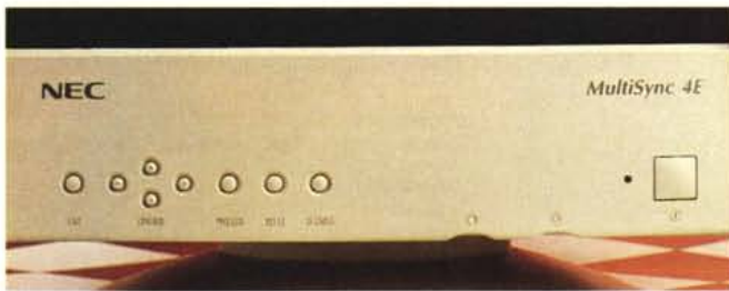
Il pannello frontale con a sinistra i pulsanti relativi alla gestione dei menu OSM.
