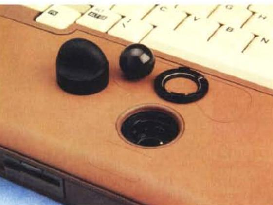
Particolare degno di nota riguardante la trackball è la ghiera blocca pallina. Per poterla svitare e pulire la parte sottostante, in quanto, come il mouse, la trackball necessita di tanto in tanto della pulitura della biglia, viene fornito un accessorio in gomma che sembra una manopola di un impianto hi-fi.
