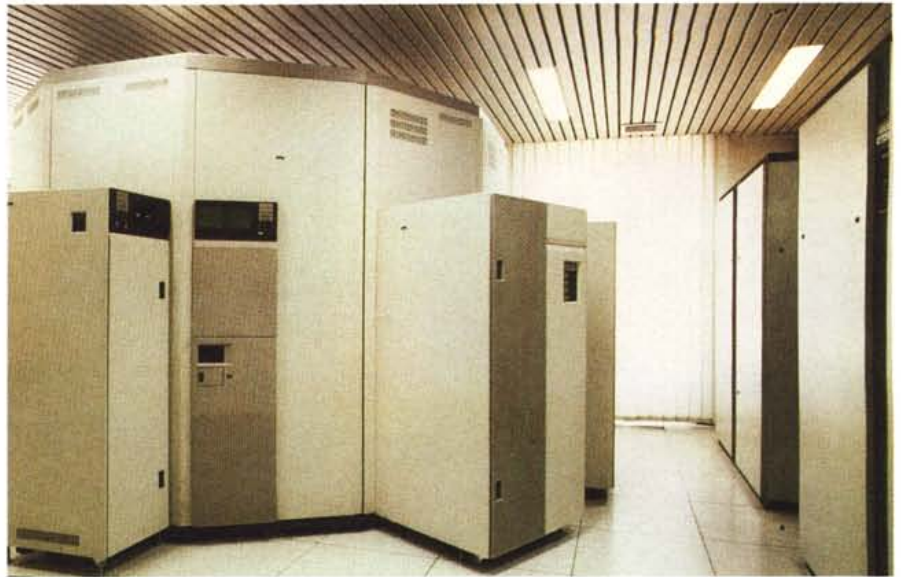
Un robot per il trattamento automatico delle cartucce magnetiche. La messa in comune delle informazioni dei singoli enti è uno degli obiettivi prioritari dell'Autorità.
