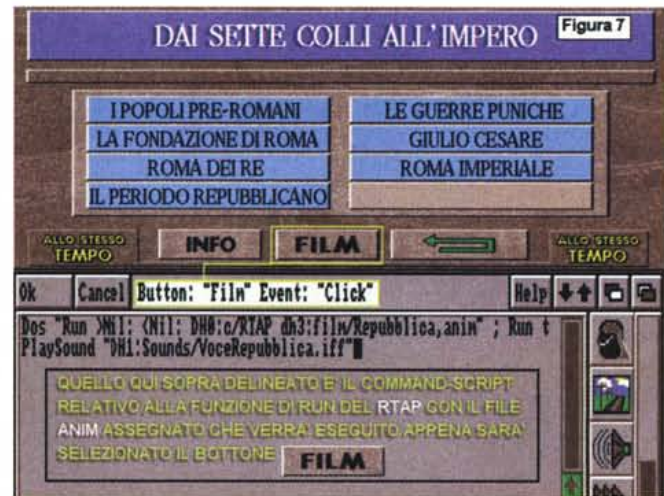
Figura 7 - Ecco cosa si cela sotto il bottone che in CanDo abbiamo dedicato al run di RTAP unitamente alla path, il nome e le opzioni dell'ANIM file.
