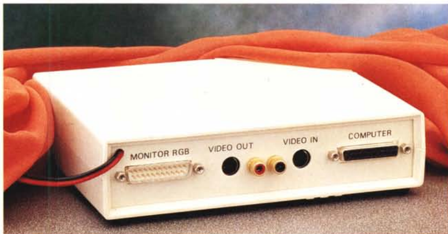
Il lato connessioni del Microgen Plus offre i classici Input/Output con cui mettere in cascata l'apparecchio all'Amiga; da sinistra a destra, l'uscita per il monitor RGB, gli Out/In video sia composito che S-VHS, l'uscita genlock verso l'Amiga.
