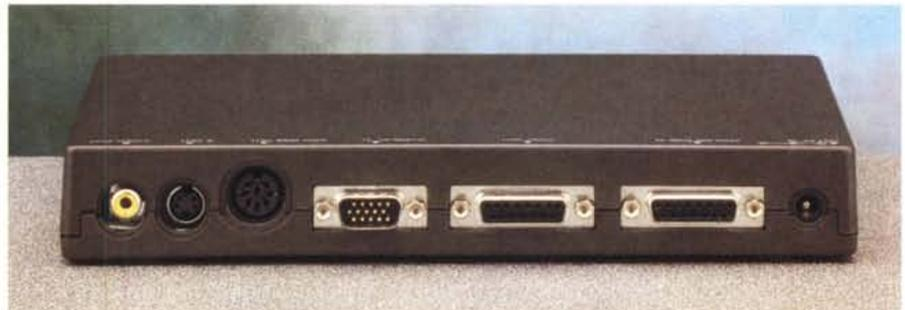
Ricca la dotazione di connessioni d'Input/Output presenti sul PCTV. Da sinistra verso destra possiamo notare le tre connessioni di uscita per il videocomposito, il SuperVideo e per l'RGB. Quindi una 15pin per l'opzionale base di overlaying, il Pass-Thru verso il monitor VGA, l'ingresso per il segnale proveniente dall'uscita VGA ed infine il connettore per l'alimentazione da 5 volt.
