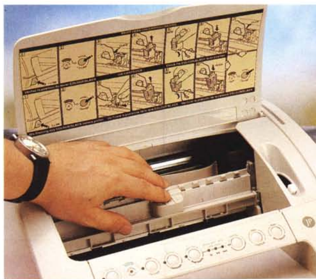
Azionando il nottolino scorrevole fino alla comparsa di inchiostro all'interno del tubicino sottostante si risolvono i problemi di intasamento della stampante.
