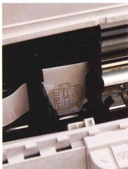
Un particolare del ricettacolo delle cartucce di stampa.
