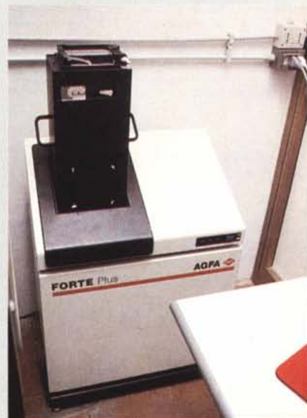
Questo apparecchio sofisticatissimo è il Film Recorder. Permette di ottenere un'immagine fotografica su pellicola da un'immagine digitale.
