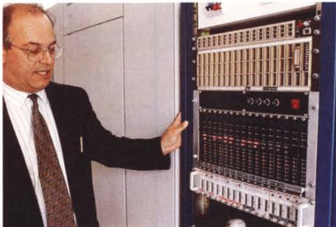
L'ingegner Maiani, responsabile del sistema informativo, mostra il rack di modem che collega il sistema centrale alla periferia.
