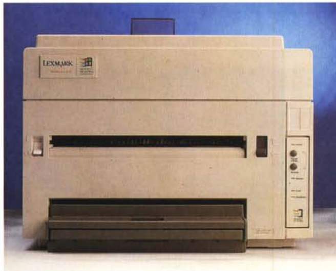
Una veduta generale del frontale. Gli unici elementi di interesse sono l'interruttore di alimentazione, la leva di selezione del vassoio di raccolta documenti e lo scarno pannello di controllo.
