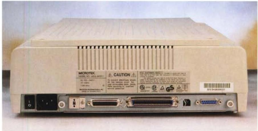
In alto il retro dello ScanMaker Iisp con la ricca dotazione di connettori per l'interfaccia SCSI e per il collegamento di unità opzionali. In basso e qui a fianco sono visibili le finestre dei Disk Accessory per la digitalizzazione a colori e B/N.
