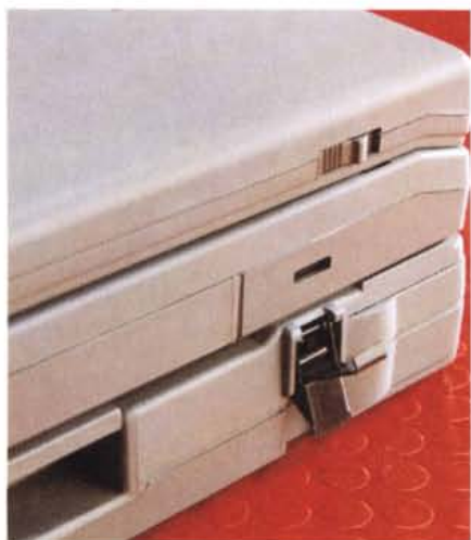
Questa docking station si integra alla perfezione nella parte bassa del notebook, a cui si collega in maniera meccanica tramite dei "ganci" che ricordano i cofani delle auto elaborate.
