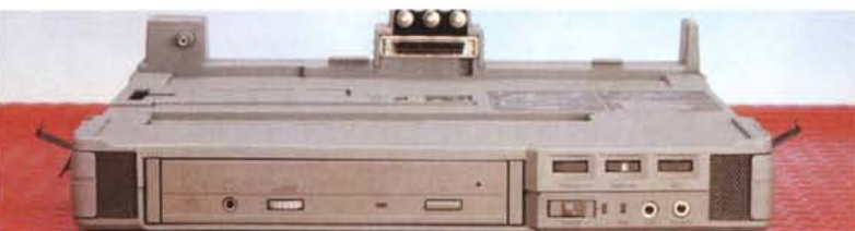
Vari particolari della docking station: il cassetto del CD-ROM che contiene tutta la parte di lettura (doppia velocità e tempo d'accesso inferiore ai 250 ms) i due altoparlanti e relative ali che ne modificano la dispersione sonora.
