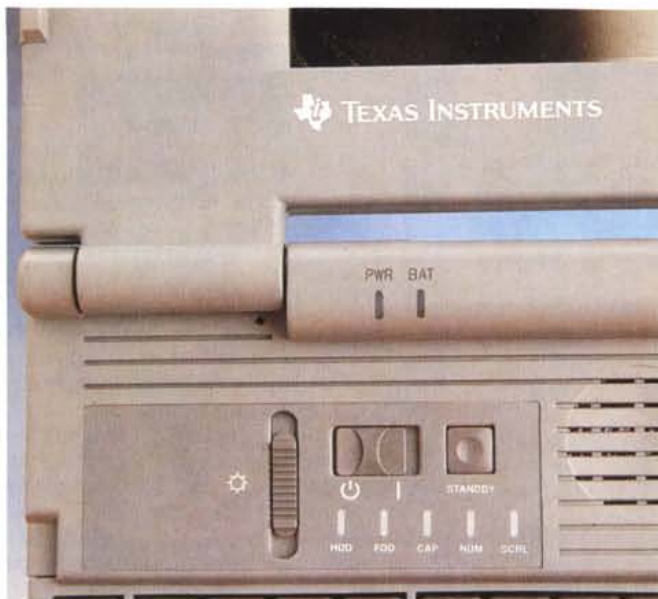
Sopra il particolare del mouse integrato e collocato alla base della tastiera, mentre a lato si vedono i cinque led che monitorano il funzionamento delle varie parti ed il controllo della luminosità del display TFT.
