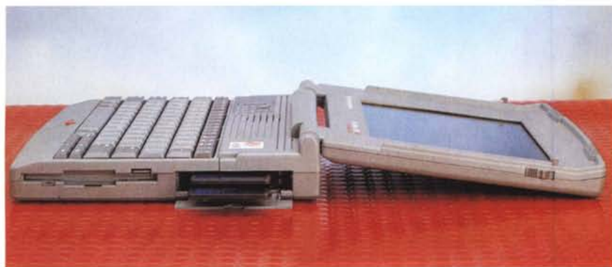
In evidenza il fatto che il display si apre a 180 gradi e lo slot per schede PCMCIA.
