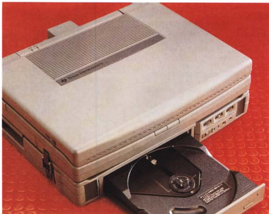
Questa docking station si integra alla perfezione nella parte bassa del notebook, a cui si collega in maniera meccanica tramite dei "ganci" che ricordano i cofani delle auto elaborate.
