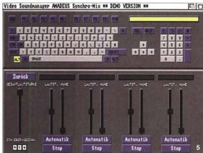
*La funzione Mixer di Amadeus, con dei comodi slider per settare i livelli di uscita.*
