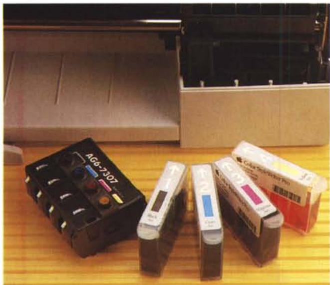
Le cartucce contenenti l'inchiostro sono quattro (nero, ciano, magenta e giallo) e sono sostituibili separatamente. Anche la testina di stampa è separata e dispone di quattro serie di ugelli per la stampa in quadricromia.
