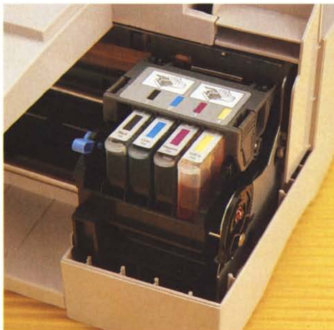
Le cartucce contenenti l'inchiostro sono quattro (nero, ciano, magenta e giallo) e sono sostituibili separatamente. Anche la testina di stampa è separata e dispone di quattro serie di ugelli per la stampa in quadricromia.
