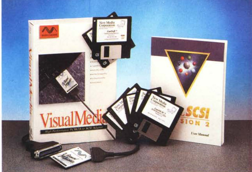
SCSI Adapter VisualMedia compatibile sia PCMCIA 2.0 che SCSI 2.0, un transfer rate di 1 Mbyte/sec in modalità burst, 0.5 Mbyte/sec in modalità sustained. Supporta 7 device logici. Nel pacchetto è compreso Corel SCSI versione 2.0 che permette di pilotare tutti dispositivi dotati di questa interfaccia.
