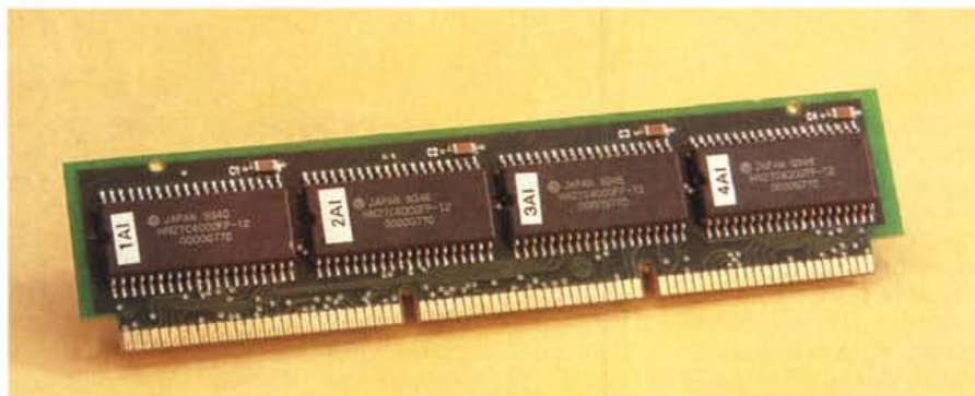
Sembra Ram e invece è ROM: si tratta del software di sistema residente.
