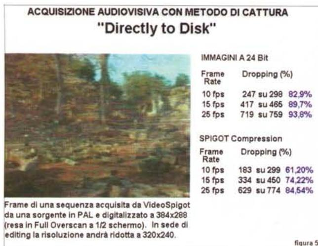
Figura 5 - A 384x288 pixel la situazione nella quale ci troviamo è purtroppo negativa. L'incidenza del Dropping è massima ed a poco serve l'inserimento della pre-compressione. Per acquisizioni a così elevata risoluzione è inevitabile il ricorso al metodo della cattura a singolo fotogramma.
