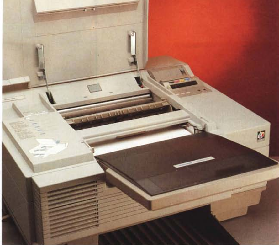
Sollevando il coperchio superiore si possono risolvere eventuali problemi di trascinamento della carta.
