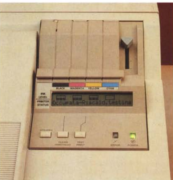
Il pannello di controllo con il vano per l'inserimento degli stick di colore e la ricca dotazione di connettori sul retro della Phaser 300i.
