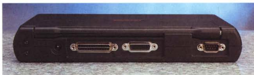
Sul retro, oltre alle porte seriale e parallela, troviamo un connettore unico per tastiera, mouse e video esterni.
