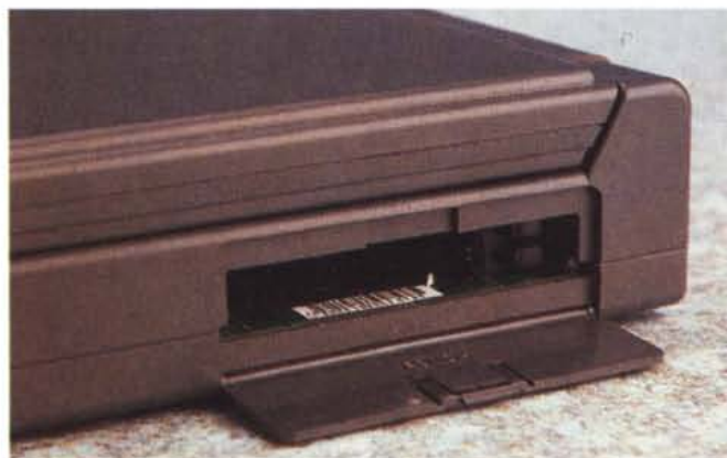
Sul lato destro della macchina troviamo l'alloggiamento per schede PCMCIA, sul retro le interfacce standard più una porta per il collegamento ad una docking station.
