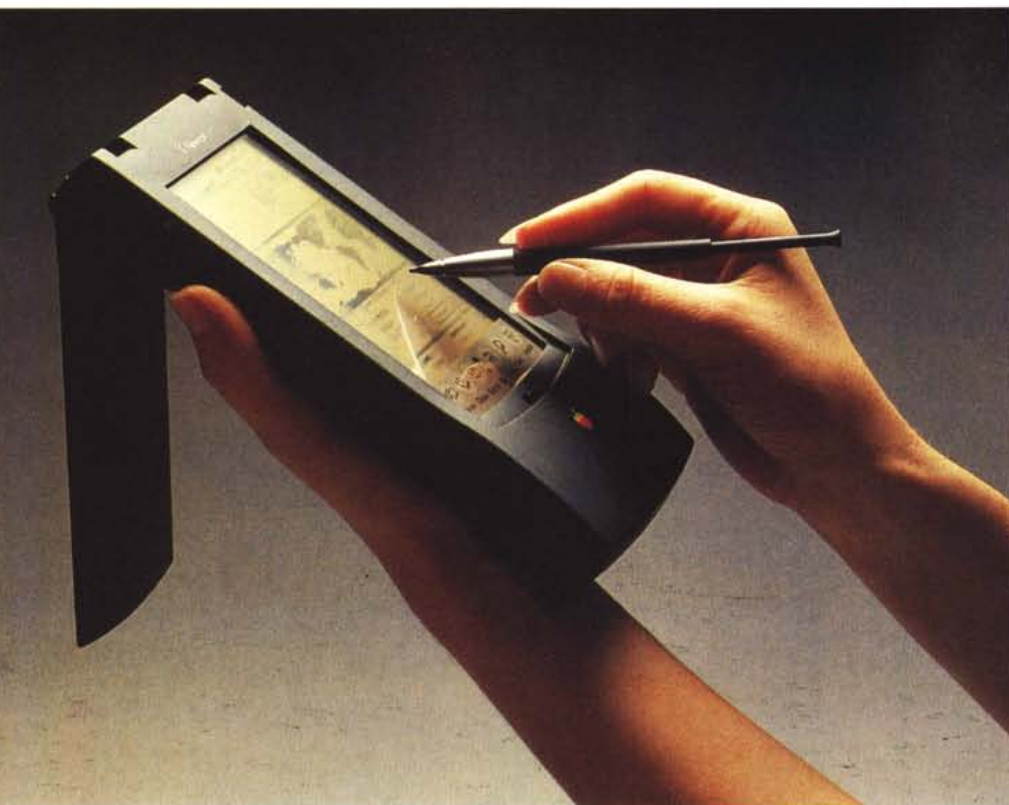
Newton MessagePad 110 ha una nuova cera: si nota immediatamente il coperchio per la protezione dello schermo.
