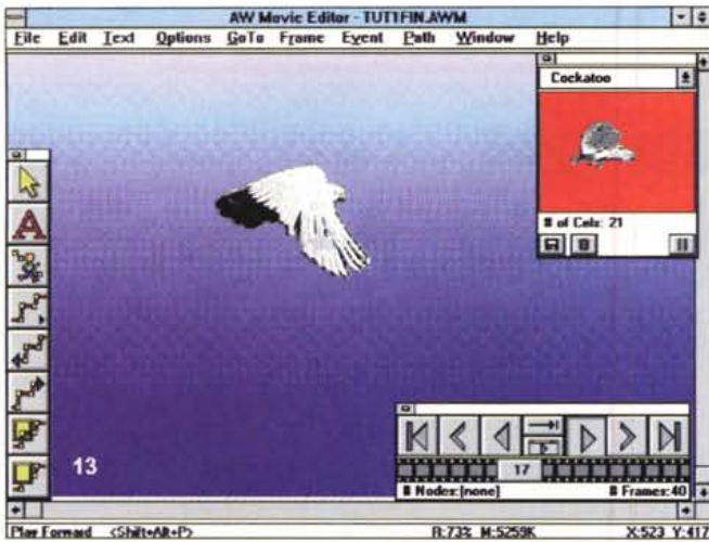
Il Movie Editor di Animation Works si presenta così; a sinistra i tool di sviluppo nella costruzione dell'animazione, in basso il controllo a mo' di VTR della sequenza ed in alto la preview della stessa.
