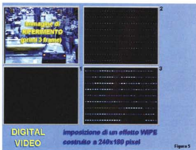
Figure 5, 6 - Effetti di transizione. Le sei maschere preparate in Paintbrush vengono ora poste sopra ai primi sei frame estratti (comando Extract del menu File di WinVideo) dalla sequenza .AVI. Salvando i riquadri così ottenuti in una dib sequence numerica (esempio: Wipe001.dib) potremo richiamarli in VidEdit (tramite il comando Insert del menu File) ed imporli automaticamente all'inizio del file digitale. Quello che vedremo riprodursi in video sarà un pregevole effetto a tendina.
