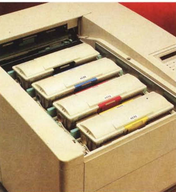
I quattro toner (giallo, magenta, ciano e nero) grazie ai quali è possibile la stampa laser in quadricromia.
