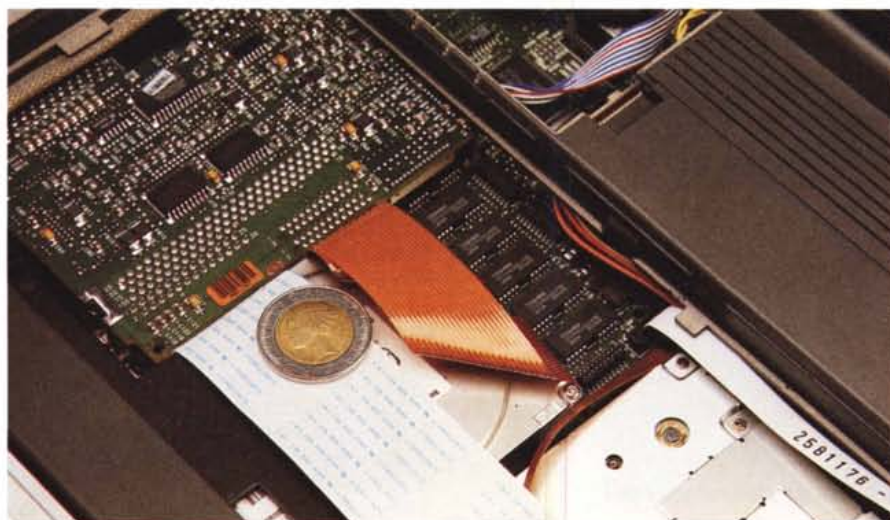
La grandezza dell'hard disk da 455 Mbyte messi a confronto con una moneta da cinquecentolire.
