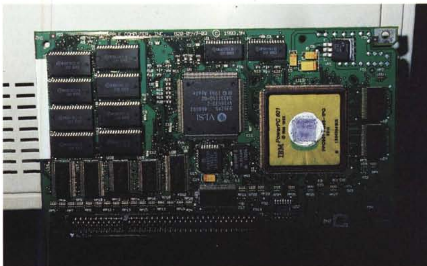
La soluzione più economica per passare a PowerPC è costituita da questa scheda PDS.
