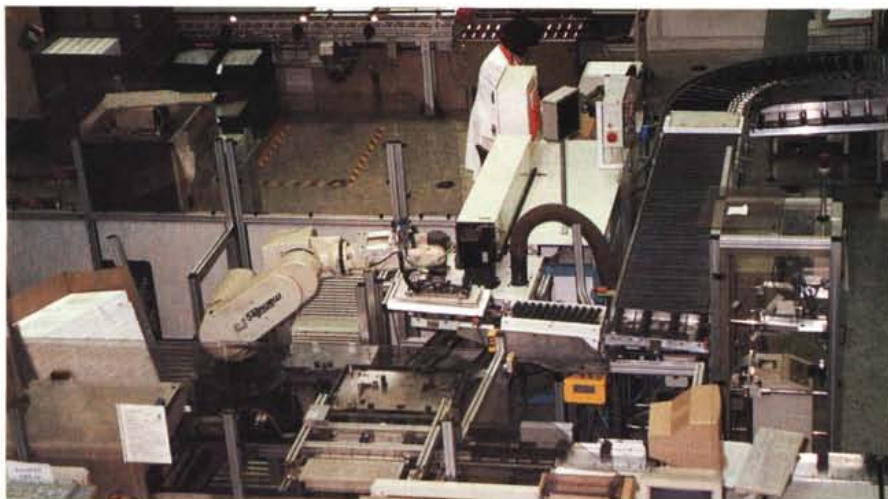
Un paziente robot imballa una per una tutte le tastiere che gli passano davanti. È stato programmato per non rompere le scatole...
