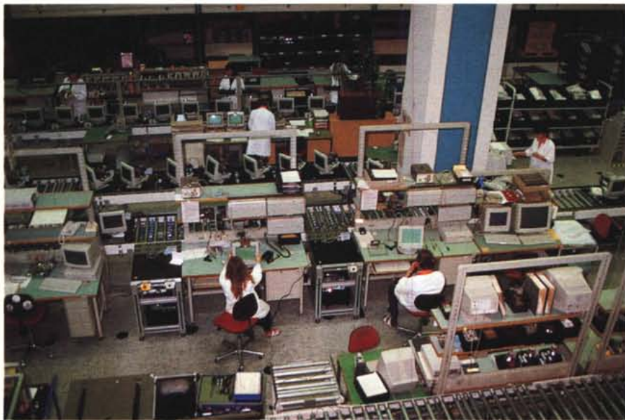
Assemblaggio, taratura e controllo dei monitor.
