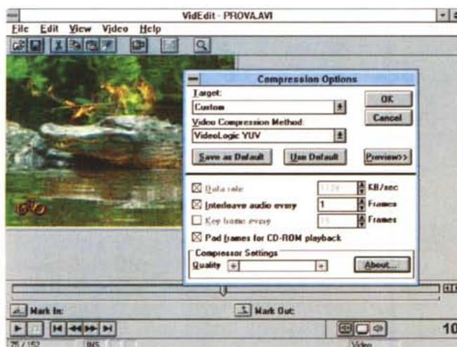
Figura 10 - Siamo in VidEdit di VFW e stiamo operando in compressione secondo la metodologia consigliata dalla VideoLogic, che con il suo formato proprietario promette una profondità colore simile al 16 bit, ma con una dimensione file prossima all'8 bit.
