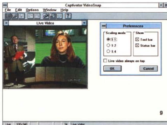
Figura 10 - Siamo in VidEdit di VFW e stiamo operando in compressione secondo la metodologia consigliata dalla VideoLogic, che con il suo formato proprietario promette una profondità colore simile al 16 bit, ma con una dimensione file prossima all'8 bit.
